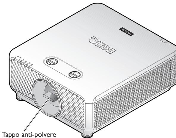
2. Quando il proiettore non è in uso, fissare il copriobiettivo fornito in dotazione con il proiettore o l'obiettivo di proiezione.
