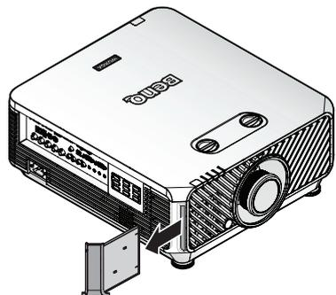
3. Sostituire il nuovo modulo del filtro con coperchio del filtro.
