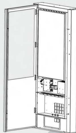
**Totem IP65 in acciaio verniciato con polveri epossidiche. Apertura frontale a libro con chiave di sicurezza ri-programmabile e vetro anteriore stratificato 6mm. Dotato di schermo ad alta luminosita' per ambienti esterni. Regolazione della temperatura interna e gestione allarmi da remoto.**
