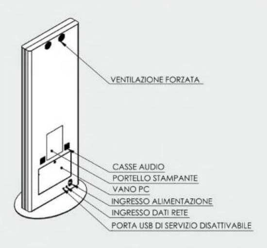
Totem interattivo adattabile alle piu' svariate realta' indoor. Puo' alloggiare al suo interno periferiche di interfaccia utente. Risponde alle principali esigenze legate al mondo del Digital Signage. Disponibile con basamento "stand alone" o predisposto per fissaggio a terra. Struttura in acciaio senza viti a vista.
